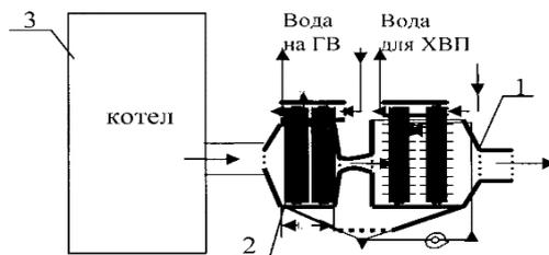
Рис. 1 - Комбинированная схема использования двухступенчатого конденсационного теплообменника
